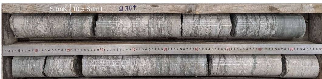
Foto 5.6. Tammiku kihistiku lubjakivi puuraugus PA-4/25. Savimergli vahekiht sügavusel 11,2 m (fotol süg. intervall 10,3 - 12,15 m).
