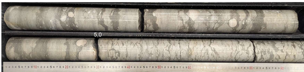
Foto 5.5. Karinu kihistiku lubjakivi puuraugus PA-1/25. Kahe eriilmelise kompleksi vahepiir sügavusel 5,0 m (fotol süg. intervall 3,7 - 5,7 m).
