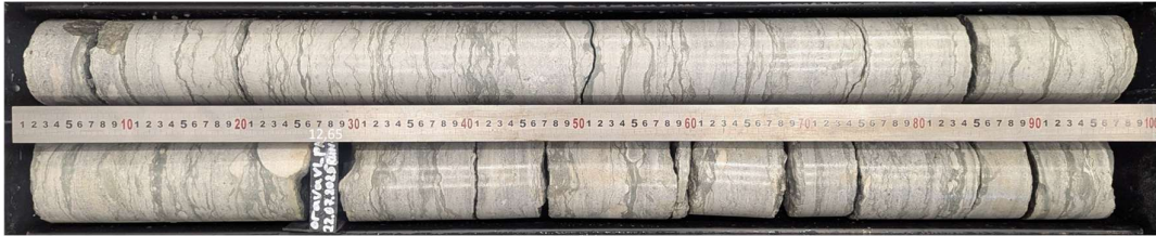
Foto 5.7. Varbola kihistu lubjakivi puuraugus PA-2/25 (fotol süg. intervall 11,4 - 13,35 m).
