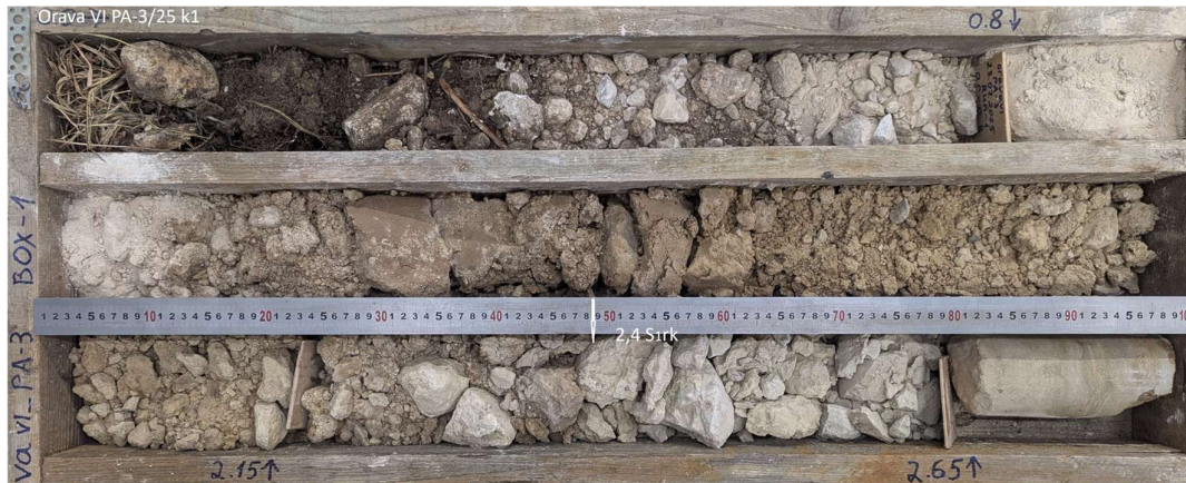
Foto 5.1. Kvaternaarisetted (kruus) puuraugus PA-3/25, fotol intervall 0,0 - 2,9 m.
