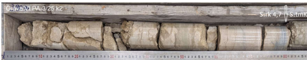
Foto 5.4. Raikküla kihistu dolomiidistunud lubjakivi puuraugus PA-3/25 (fotol süg. intervall 3,9 - 4,75 m)
